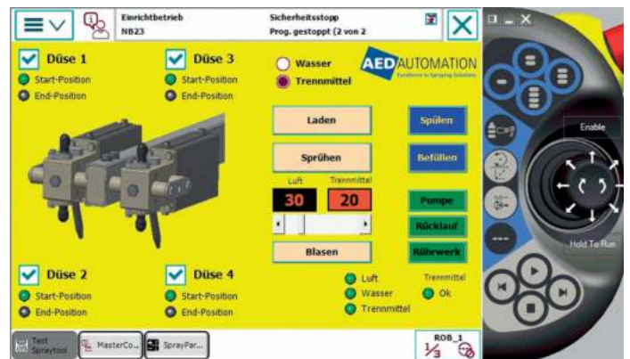
Bild 6: Bedienoberfläche, Bilder 3 bis 6: AED Automation
